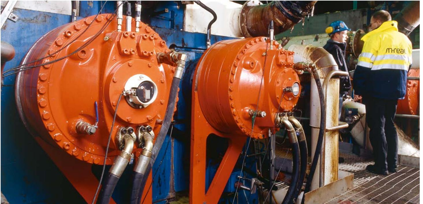
赫格隆 CB 系列马达适用于许多重载应用，比如破碎机、给料器和辊式轧制机。它具有很大优点，比如节省设计空间、具有多种通用的安装可选方案。
